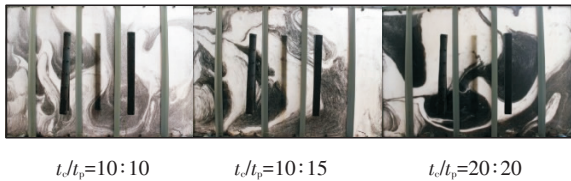
图8 不同脉冲时间下的砂堤分布 Fig. 8 Sand embankment distribution with different pulse time
